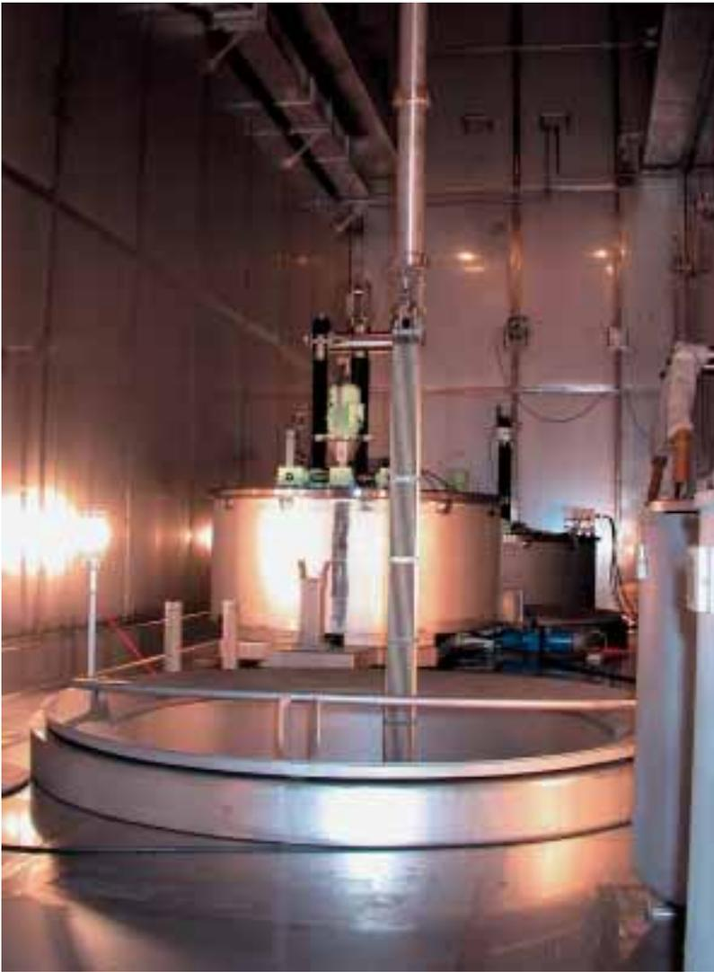
**In der Heissen Zelle werden Brennelemente ferngesteuert in einen TL-Behälter umgeladen.**
