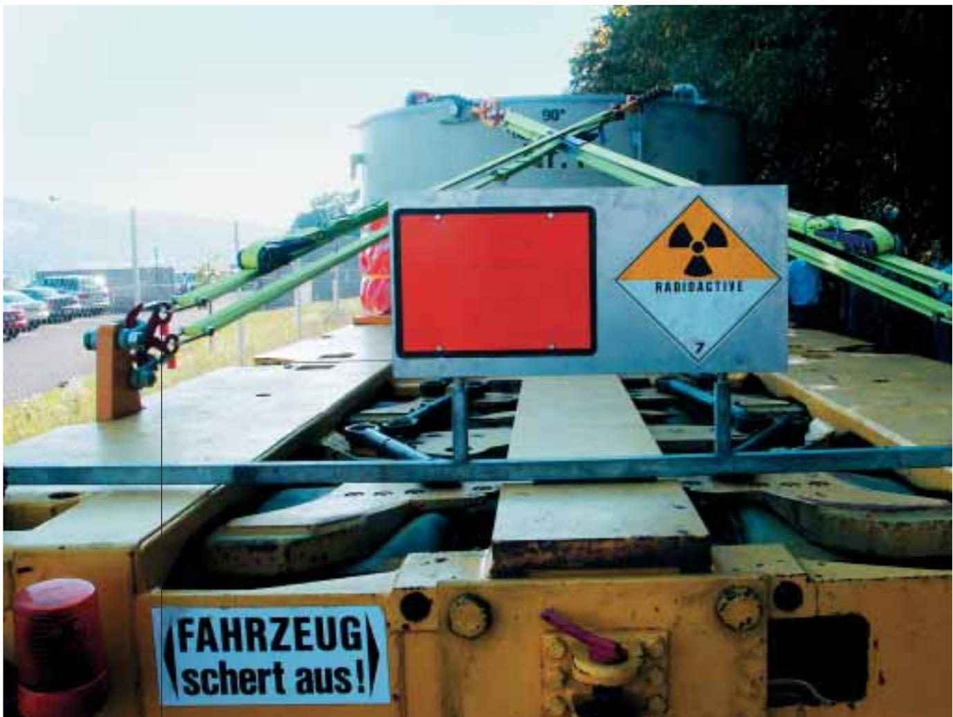
Im September 2003 erfolgte eine Rückführung von verglasten hochaktiven Abfällen aus der Wiederaufbereitungsanlage der COGEMA. Der Transportbehälter wurde an der Umladestation der ZWILAG vom Bahnwagen auf ein spezielles Transportfahrzeug der ZWILAG umgeladen und anschliessend zum Betriebsareal der ZWILAG transportiert. Auch bei diesem Transport wurden keine Überschreitungen der gefahrgutrechtlichen Grenzwerte festgestellt.
