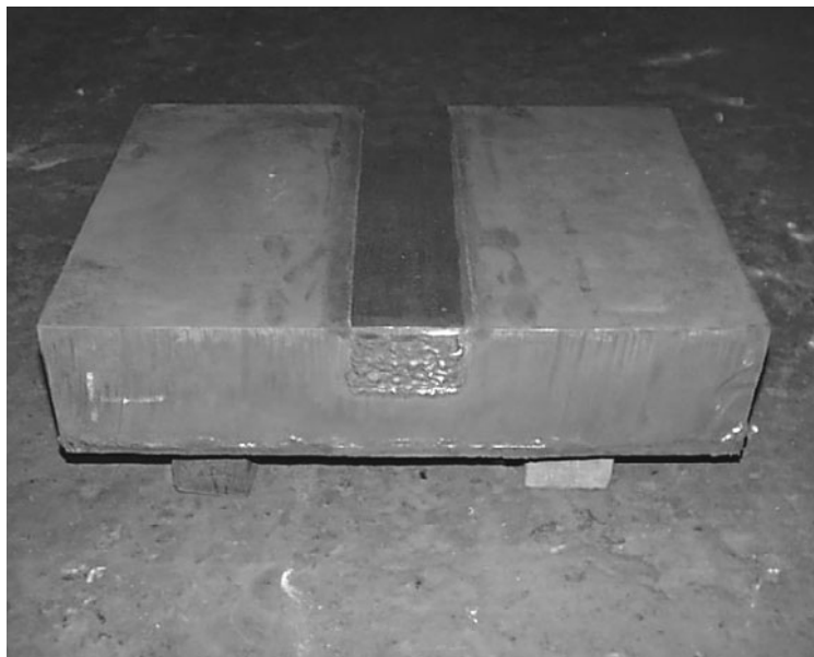
Figur 3: Simulierte Inconel-182/SA 508 Cl. 3-Mischnaht zum Studium des Korrosionsrisswachstumsverhalten im Übergangsbereich zwischen Inconel-182-Schweissgut und unbeeinflusstem RDB-Grundwerkstoff.
