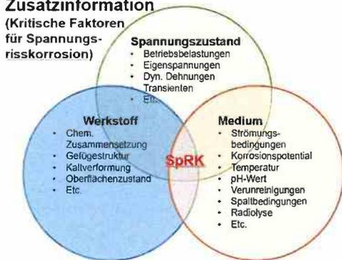
Nur wenn drei Faktoren erfüllt seien, gebe es Spannungsrisskorrosion (SpRK), dies entspreche der Schnittmenge der drei abgebildeten Kreise.
